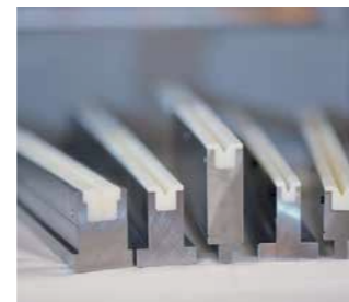
Матрицы с полиуретановыми и композитными вставками
