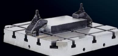
Монтажные (или стендовые) чугунные плиты широко применяются на многих сварочных производствах при сварке массивных, крупногабаритных деталей. Основой системы фиксации обрабатываемых изделий являются прецизионные пазы в рабочей поверхности плиты, выполненные с заданным шагом по ее длине и/или ширине (а в ряде случаев – по диагонали), исполненные, в виде перевернутой буквы «Т», из-за чего их часто называют Т-паз или Т-слот.
