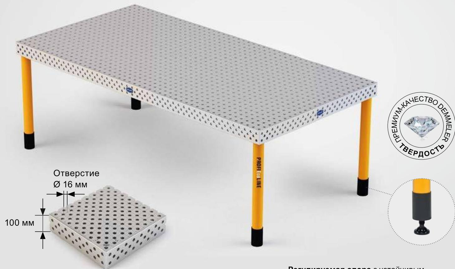
**Регулируемая опора** с устойчивым резьбовым шпинделем М 30 x 2, с возможностью точной регулировки  $\pm 24$  мм
