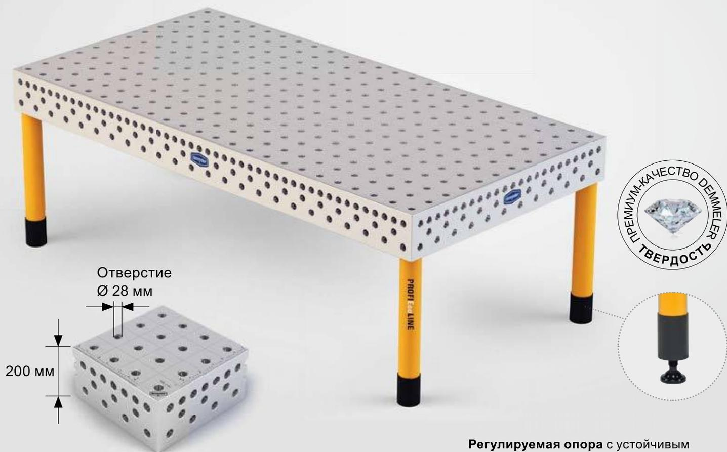
**Регулируемая опора** с устойчивым резьбовым шпинделем М 30 х 2, с возможностью точной регулировки  $\pm 30$  мм. **Манжета опоры** препятствует заземлению сварочного шланга и защищает резьбовой шпиндель от загрязнения.
