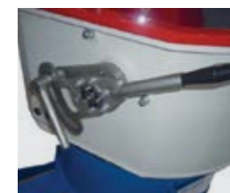
Ручное / автоматическое управление заслонкой сепаратора
